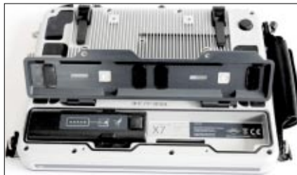
In das Akku-Fach passen zwei Akkus, die sich unabhängig voneinander einsetzen oder wechseln lassen
