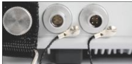
An die Spezialkontakte lassen sich die mitgelieferten Kabel anschließen wie beispielsweise für serielle Verbindungen, Netzwerk oder USB
