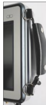
▲ Der Tragegriff ermöglicht einen sicheren Halt der teuren Hardware beim Outdoor-Einsatz
