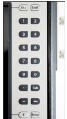
▲ Zusätzlich zur einblendbaren Tastatur bietet der colibri X7 auch eine Folientastatur für die direkte Zahleneingabe
