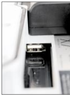
◀ Gut geschützt im Akku-Fach befinden sich zwei der insgesamt drei USB-Ports
